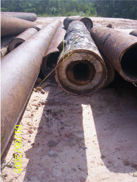
Gambar 4. Pipa bekas pengeboran minyak dan gas yang mengandung *scale*
