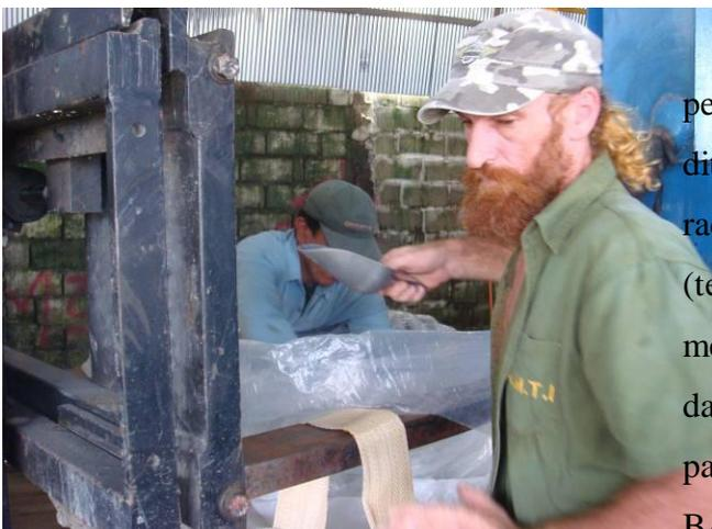
Dari hasil kunjungan ke instalasi pengolahan pasir zirkon di Kalimantan, para pekerja melakukan pekerjaan tanpa alat perlindungan diri yang memadai. Para pekerja tidak menggunakan alat proteksi pernapasan ataupun pengontrolan debu yang memadai seperti terlihat pada gambar di bawah ini.
