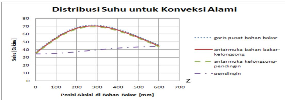
Gambar 7. Distribusi suhu di kanal panas, pengambilan panas dengan konveksi alami
