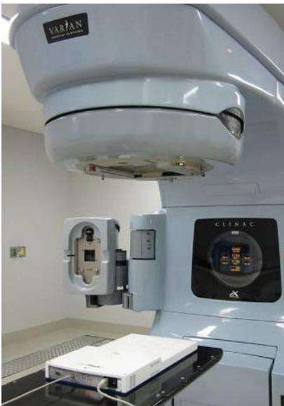
**Gambar 6.** Pengecekan Output Linac dengan IBA Dosimetry StarTrack\*
