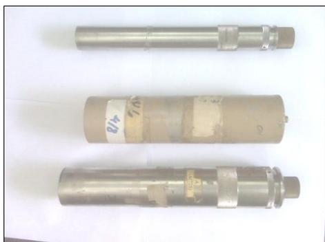
Gambar 2. Detektor sintilasi berbagai ukuran
