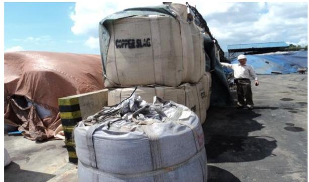
Gambar 3. Limbah hasil buangan proses *sand-blasting* yang berpotensi mengandung TENORM di kemas dalam karung vinyl kapasitas 1 ton, dan ditumpuk didalam ruangan.
