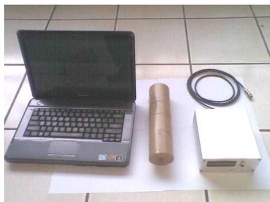
Gambar 5. Peralatan pendeteksi sumber gamma
