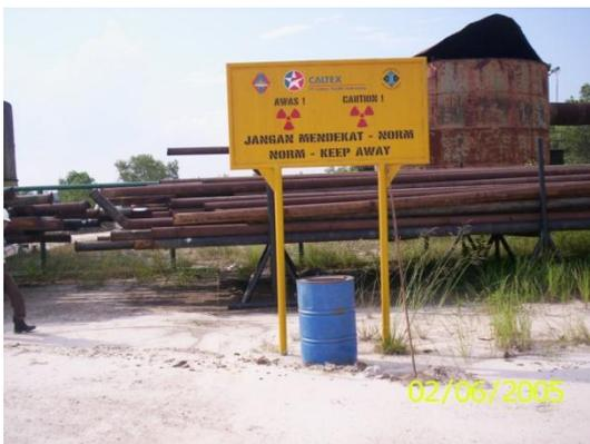
Gambar 1. Lokasi Timbunan pipa bekas pengeboran minyak dan gas yang mengandung *Scale*
