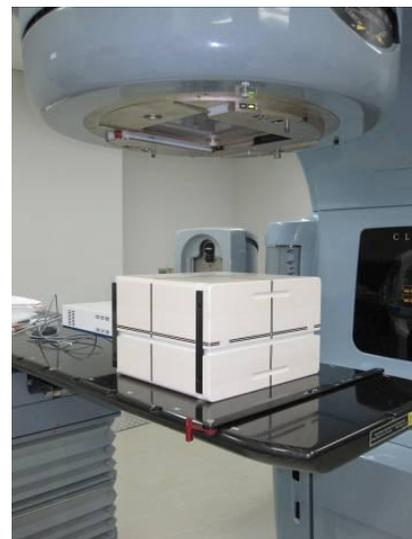
**Gambar 7.** Setup MatriXX Evolution untuk verifikasi IMRT
