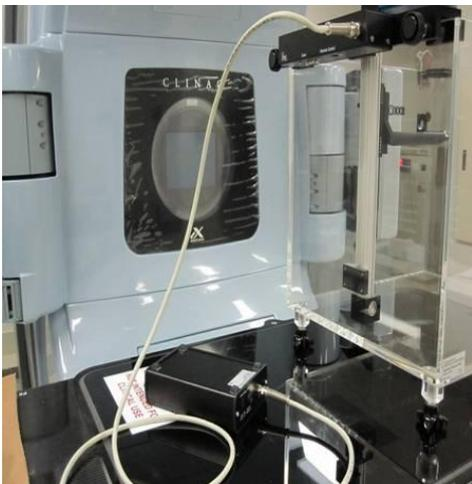
**Gambar 5.** Pengecekan Output Linac dengan bilik ionisasi tipe Farmer dan *Solid Water Phantom*
