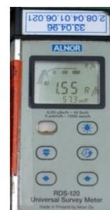
Gambar 1. Surveymeter terkalibrasi
